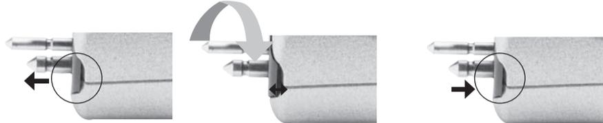
Hinweis: Beim Ausrichten der Stifte niemals Kraft anwenden, da die Stifte beschädigt werden können, wenn sie überdreht werden.
